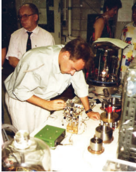
Fot. 86. Kongres WCU'1997. Wizyta naukowa w Institute of Technology w Tokyo; Precision & Inteligence Lab, stanowisko montażu minisilników ultradźwiękowych (zob. Śliwiński 2001)
