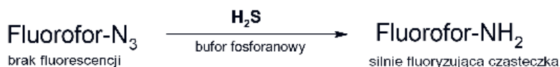
Rysunek 3. Ogólny schemat reakcji redukcji próbnika zawierającego grupę -N_3 w obecności H_2S
