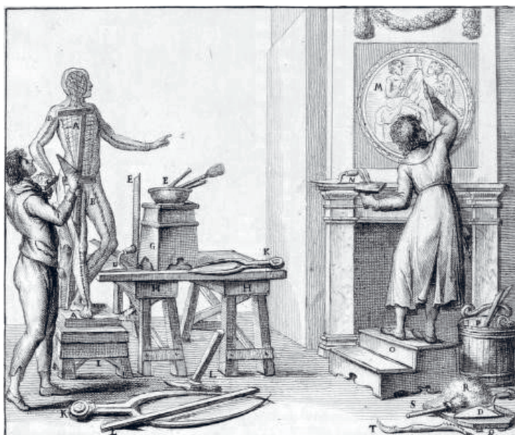
Ill. 3. Carradori Tavola VII. «Nella quale viene dimostrato il modo di lavorare in Stucco qualunque oggetto di Scultura, tanto in Basso, come in Tutto-rilievo, suoi necessarij Attrezzi, Ferri, e loro Nomi». Fra Francesco Carradori, Istruzione elementare per gli studiosi della scultura (Firenze 1802) Internet archive. [Nettadresser er ikke tillatt i gratisversjonen av Filemail]
