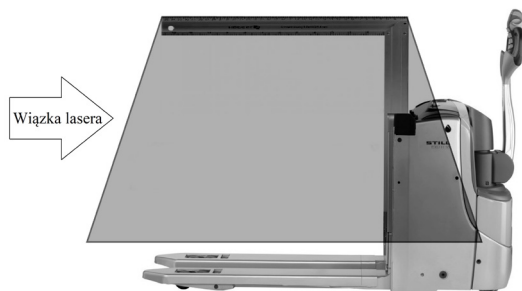
Rysunek 2: Czytnik kodów kreskowych zamontowany na wózku
