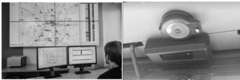
Rys. 3. Od lewej: Centrum zarządzania transportem publicznym w Rzeszowie, od prawej: system zliczania pasażerów w pojazdach
