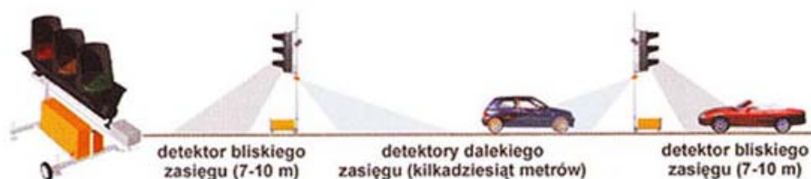
Rys. 1. Schemat detekcji pojazdów na drogach
