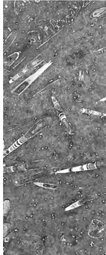
Il. 3. Ordowicki wapień olandzki (warstwa czerwona), próbka kamieniarska z widocznymi skamieniałościami ordowickich głowonogów-łodziaków z gatunku Orthoceras
