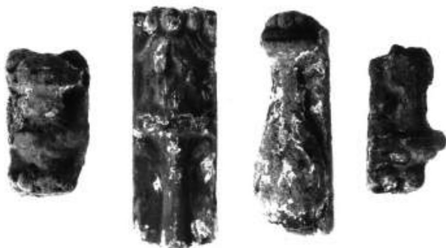
8. Gliniane listwy osłaniające fugi. Pod licznymi przemalowaniami zachowana pierwotna polichromia
