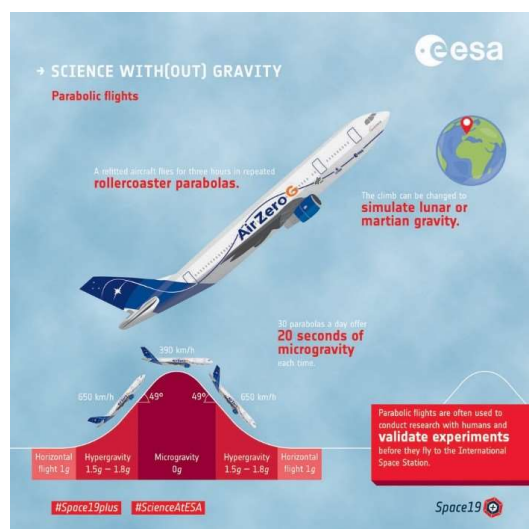
Ryc. 4. Schemat lotu parabolicznego przygotowany przez ESA ([5])
