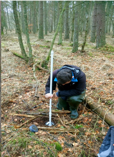
Ryc.8. Pobieranie próbki wody z piezometru
