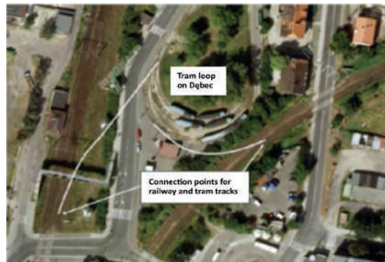
Figure 8. Possible variants of connecting the tram terminal in Dębiec with the railway node Source: P. Kuczyński, Tramwajowy transport towarów w aglomeracji miejskiej Poznania , Diploma thesis, Poznań 2010
