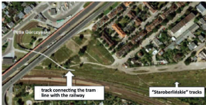
Figure 7. The proposed connection of the tramway loop on Górczyn with railway tracks Source: P. Kuczyński, Tramwajowy transport towarów w aglomeracji miejskiej Poznania , Diploma thesis, Poznań 2010
